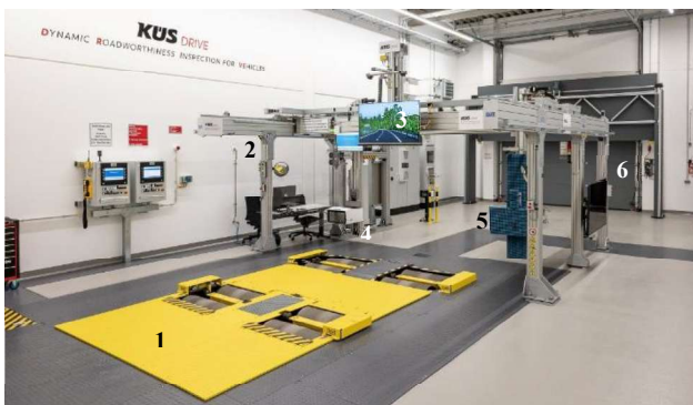
Bild 1: Prinzipieller mechanischer Aufbau der Prüflinie KÜS DRIVE [1] mit Beschreibung der wesentlichen Anlagenteile gemäß der Nummerierung siehe Text unten: (1) Lenkbarer Funktionsprüfstand (SFT). Auf dem SFT kann das Fahrzeug ohne Fixierung inklusive moderater Lenkbewegungen bis 130 km/h gefahren werden. Hierbei wird die Fahrzeugsymmetrieachse des Kraftfahrzeuges mittels eines Messsystems, während der Fahrt auf die Symmetrieachse des SFT positioniert. (2) Portalsystem zur Positionierung des Monitors (3), des Lichtsammelkastens (4) und des Radar-Target-Simulators (RTS) (5) vor das Fahrzeug. (6) „10 Meter Wand“ zur Vermessung u.a. des adaptiven Fernlichts (AFS).
